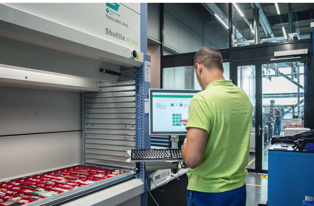
1 Ein solches Werkzeugentnahmesystem mit User-Interface, hier mit offenem Tablar, gehört zu den Kernkomponenten eines weitgehend digitalen Toolmanagement-Systems
